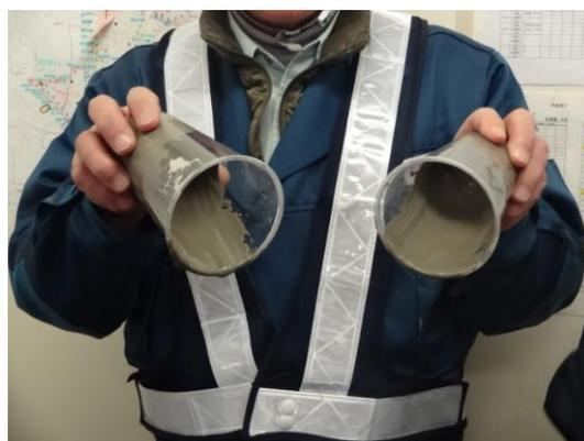
↑ 端部充填剤は固化が早く、粘度の高い充填剤で、充填現場まで2本のパイプラインで原材料を送り、充填直前に混ぜ合わせる。A液B液を混ぜ合わせて固化した様子。
