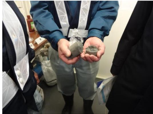
↑ 充填箇所から試験掘削(確認ボーリング)にて取り出した充填剤。固化が完了した状態でも、柔軟性のある土や粘土のような状態。将来の土地利用の支障にはならない。
